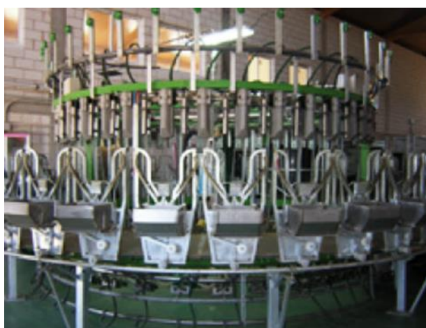
Imagen 2.5: Instalación fija de ordeño de tipo rotatorio (Westfalia; s.f. a)
