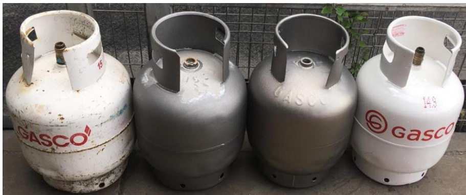
Ilustración 1.3. De izq. a der. Cilindro deteriorado, cilindros granallados y cilindro pintado Fuente: elaboración propia con acceso a la planta
