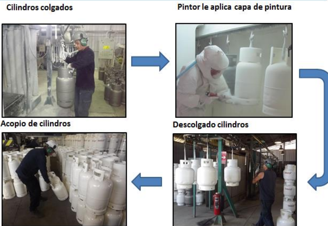
Ilustración 1,23 Secuencia proceso de pintura
