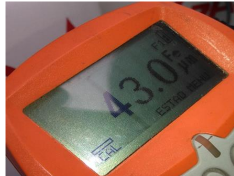
Ilustración 1.6. Medición de espesor a cilindro Fuente: Departamento calidad ECSE
