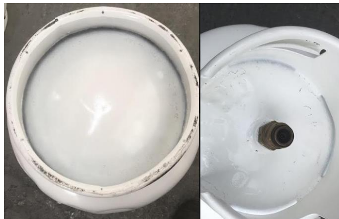
Ilustración 1,8. Cilindros pintados defectuosos Fuente: elaboración propia con acceso a la planta
