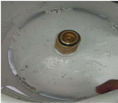
Ilustración 1.5 Cilindro pintado defectuoso Fuente: Departamento calidad ECSE
