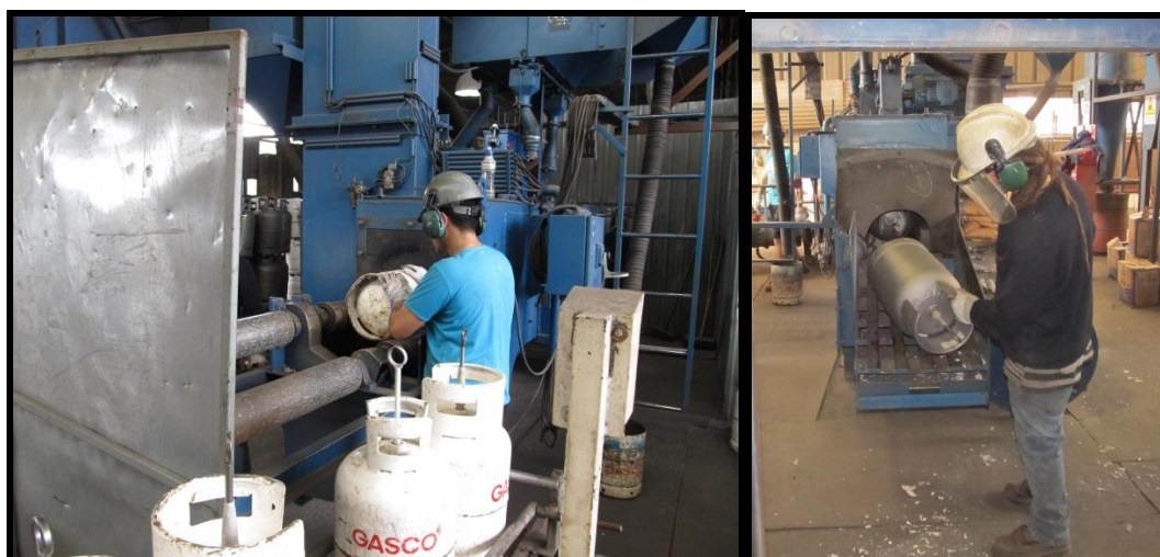
Ilustración 1.4. Cilindros en proceso de granallado Fuente: elaboración propia con acceso a la planta
