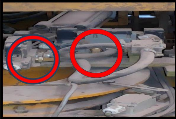
Instalación de silenciadores porosos de bronce en pinzas de Desapiladora, Apiladora
