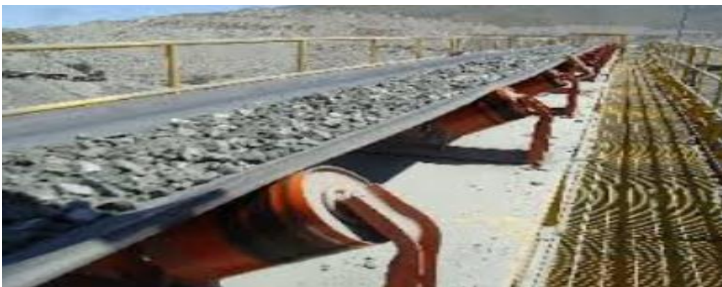
Figura 14.1: Rodillos metálicos y de impacto
