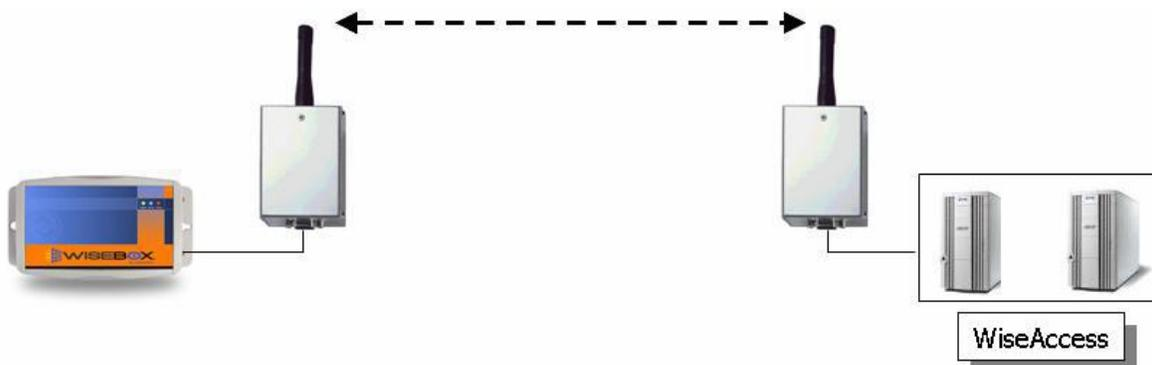
Imagen 5.3 Conectividad de la Wisebox mediante GPRS
