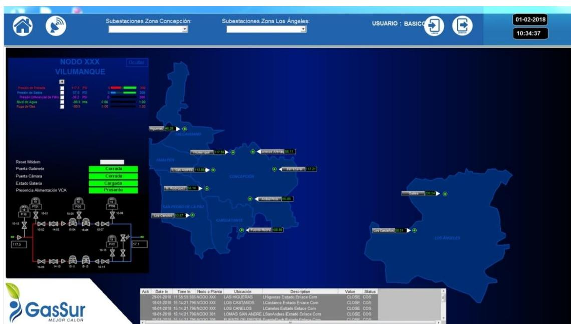
Imagen 5.10: Sistema SCADA Monitoreo Red Matriz de Gas.
