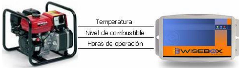
Imagen 5.1: Supervisión de un generador mediante Wisebox
