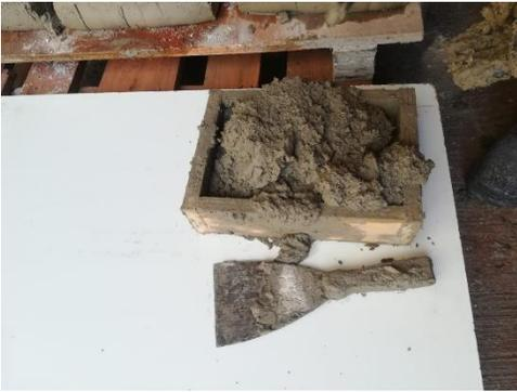
4. Posteriormente la pasta homogenizada se vierte en moldes previamente fabricados de medidas 7x15x23cm. En el mercado los ladrillos tienen medidas de 15x5x30, pero se puede solicitar a pedido medidas especiales. En este caso la diferencia con los de fabricación propia no incide en el resultado final de mediciones ya que las muestras se prepararán para dichas pruebas.
