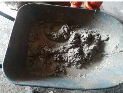
Para preparar el relave acondicionado (Agregado de construcción) se debe mezclar de la siguiente manera: Las proporciones indicadas son 75% de relaves, 10% Cal y 15% de Cemento, lo que corresponde a 15 Kg de relaves, 2 Kg de Cal y 3 Kg de Cemento. Una vez homogenizada la mezcla se agregan las proporciones para la fabricación del ladrillo propiamente tal, se agrega agua hasta tener
