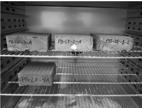
En el caso de esta preparación no se contaba con el espacio ni la cantidad suficiente de ladrillos para montar un horno, sin embargo el laboratorio de mecánica de rocas UDLA cuenta con 2 hornos, los que alcanzan temperaturas de 300°C. La bibliografía revisada indica que los ladrillos se pueden cocer entre 90° y 900°C, por lo cual se tomó la decisión experimental de cocer 5 ladrillos a
