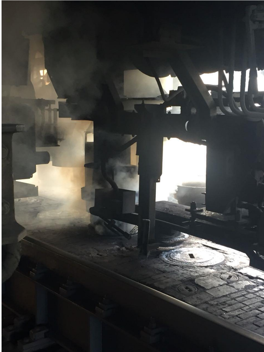
Ilustración 7-3: Proceso carga de hornos
