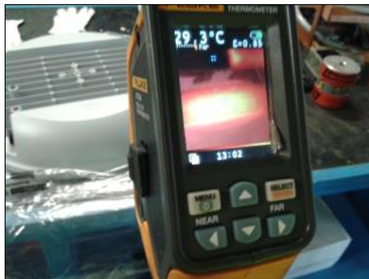
Figura 3.3 Medición de temperatura exterior de los equipos.
