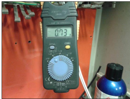
Figura 3.2 Medición de consumo de corriente de los equipos.
