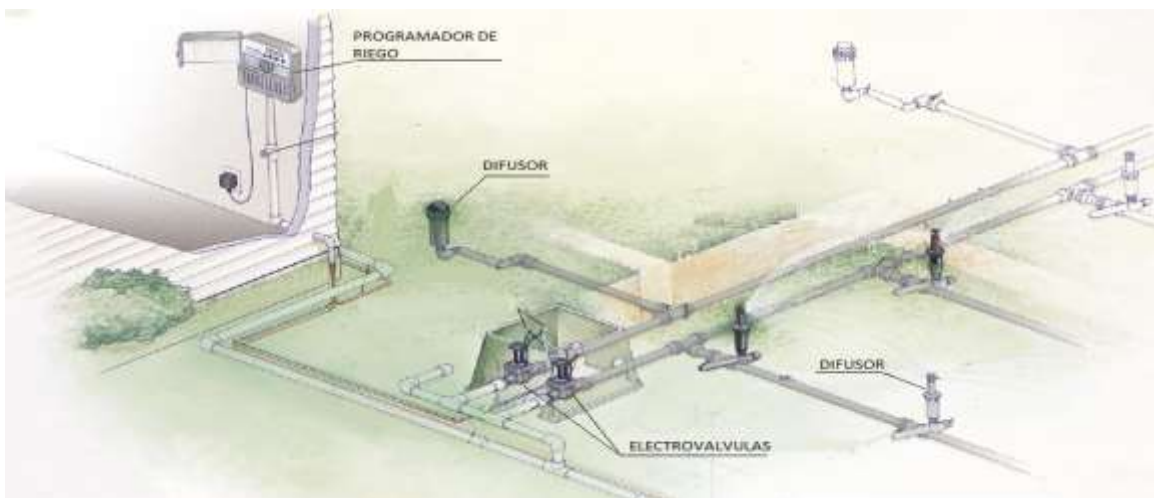
Figura 1.3 Esquema de sistema de riego automatizado
