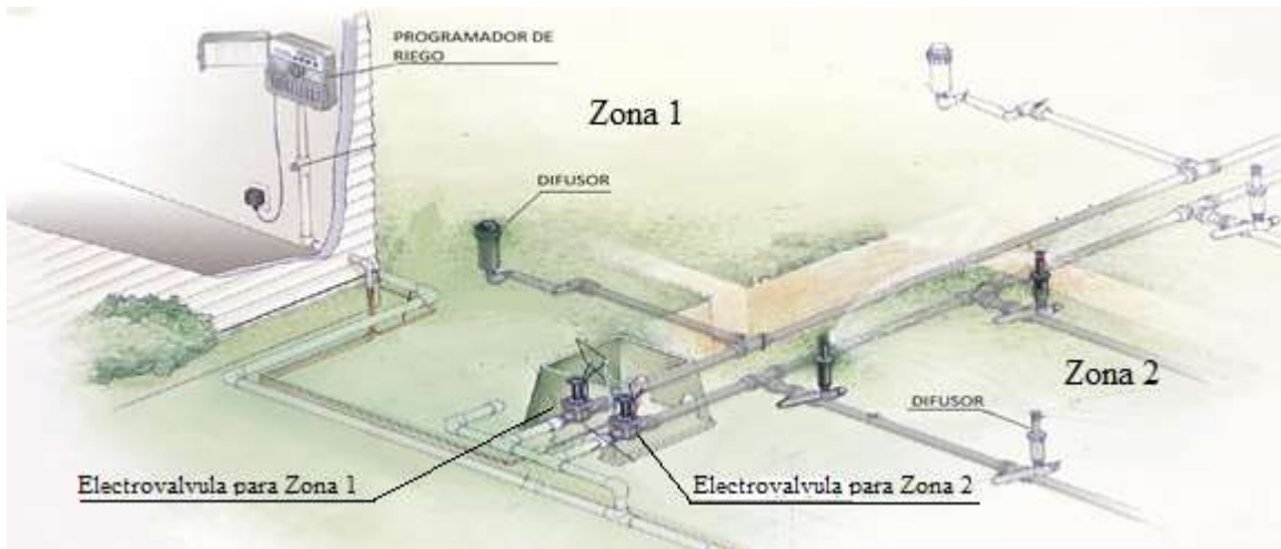
Figura 2.3. Instalación típica de riego de 2 Zonas
