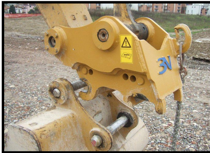
Ilustración 20: Sistema de anclaje excavadora Komatsu PC120
