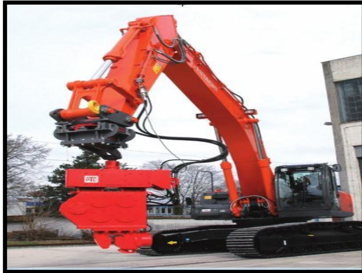
Ilustración 28: Vibro 6PHFV PTC montado en máquina excavadora Doosan
