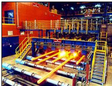
Imagen 11: Etapa de Colado, CAP Acero.
