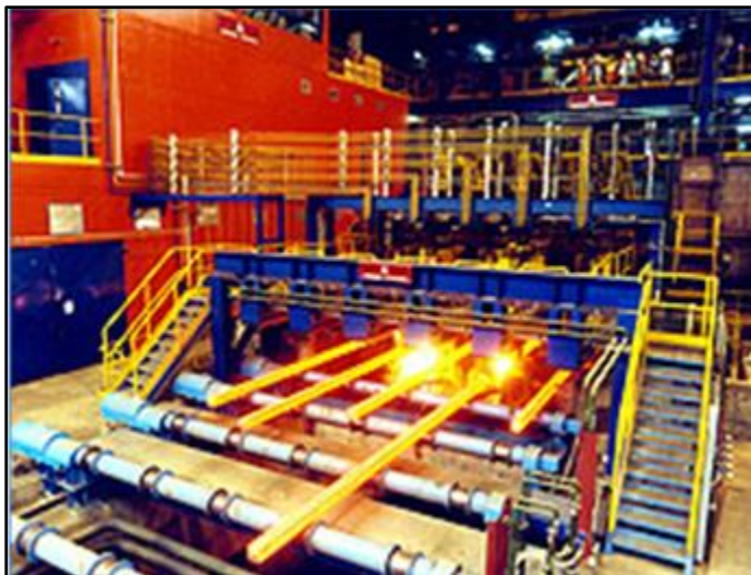
Imagen 24: Colada Continua de Palanquillas, CAP Acero
