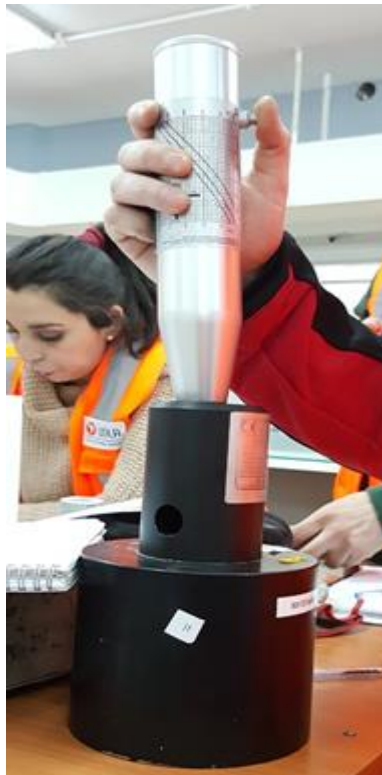
Imagen 14: Procedimiento de calibración del Martillo Schmidt.
