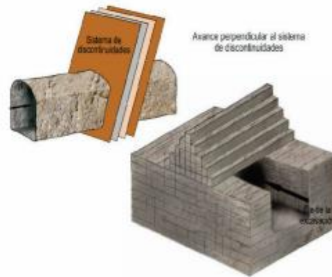
Condiciones de avance muy favorables para la estabilidad. La estructura funciona a manera de varillas apiladas en forma perpendicular a la excavación, las mismas que presentan buena estabilidad.
