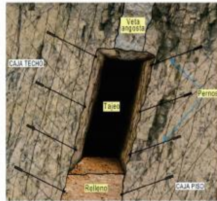
Avance paralelo al sistema de discontinuidades. Condición desfavorable.
