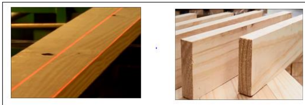
Figura 2.5 Madera que ingresa a selectiva y block obtenidos en trozado
