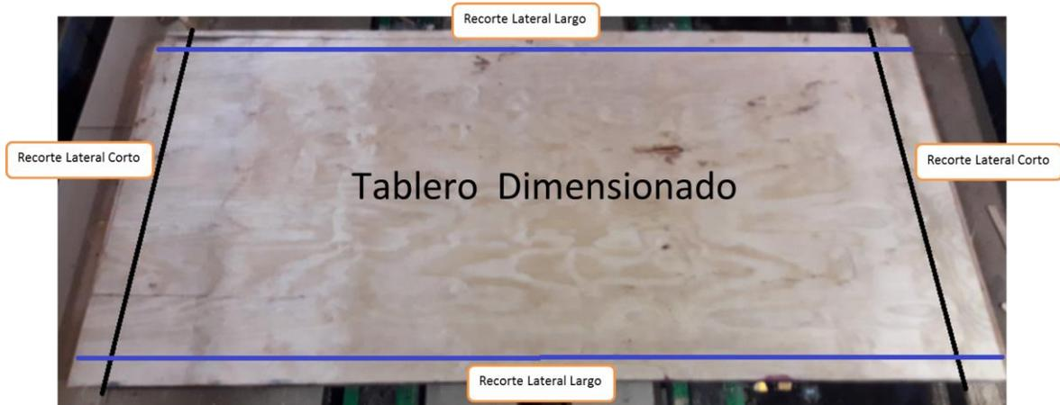
Figura N° 1.2. Tablero Dimensionado y sus respectivos recortes laterales.
