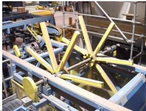
Figura N°1.7.Componentes de escuadradora: 3 clasificación de tableros.
