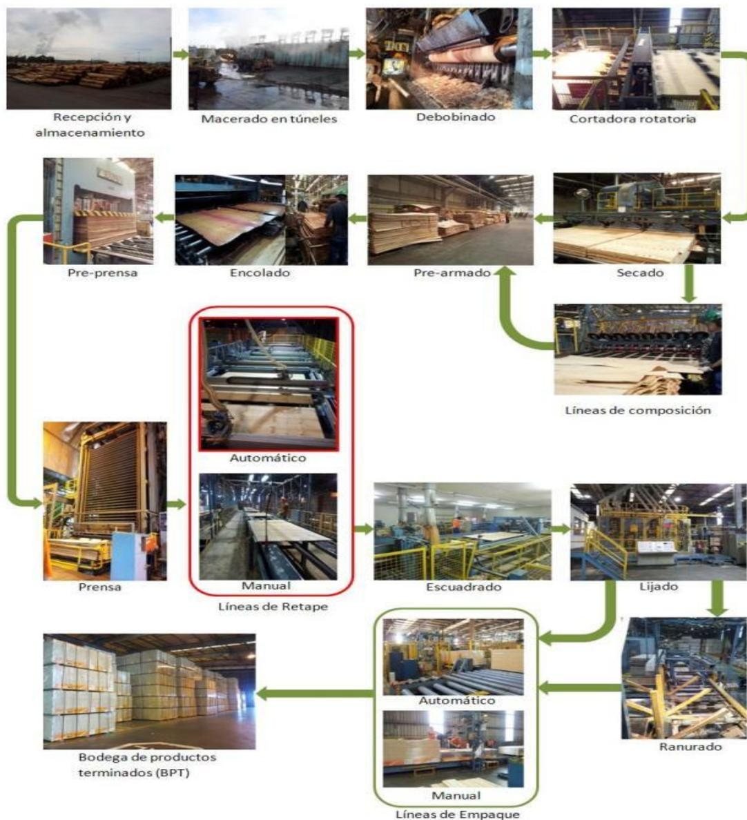
Figura N°2.4 Muestra proceso de fabricación del tablero contrachapados.
