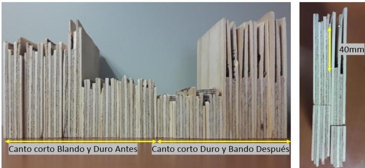
Figura N°4.2 Muestra el recorte lateral de escuadrado antes y después de las propuestas
