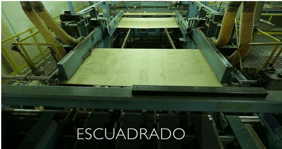
Figura N°2.13 Muestra una escuadradora de tableros.
