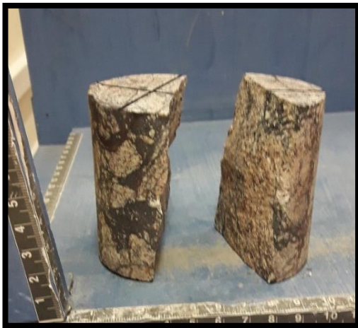
Imagen N° 11, Muestra con fractura tipo T
