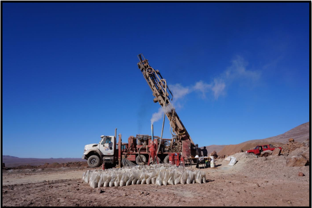
Imagen N° 14 Sonda Schramm T685WS en proceso de perforación.
