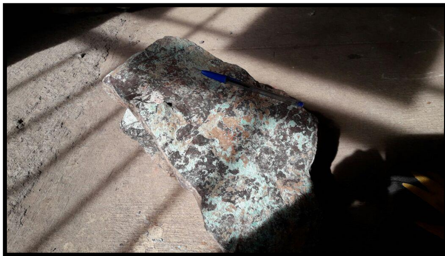
Imagen N° 2 Roca muestra de Brecha Hidrotermal.
