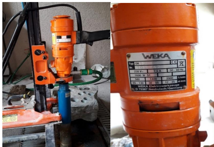
Imagen N° 4, Máquina perforadora utilizada
