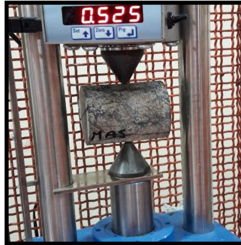
Imagen N° 10, Muestra Instalada en las puntas cónicas.
