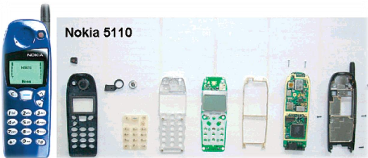
Figura 5 Teléfono móvil desmantelado en sus posibles materiales a recuperar (PCB's). (Khannaa, Cayumil, Mukherjee, & Sahajwallaa, 2014)
