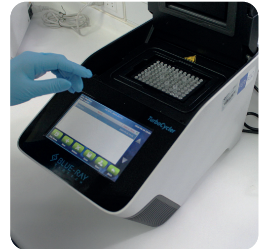
Termociclador para la amplificación de ADN mediante la técnica de PCR convencional.
